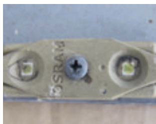
Schmutz in der LED-Mulde und Korrosion der Befestigungsschrauben
