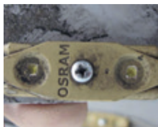
Schmutz auf den Oberflächen der LEDs
